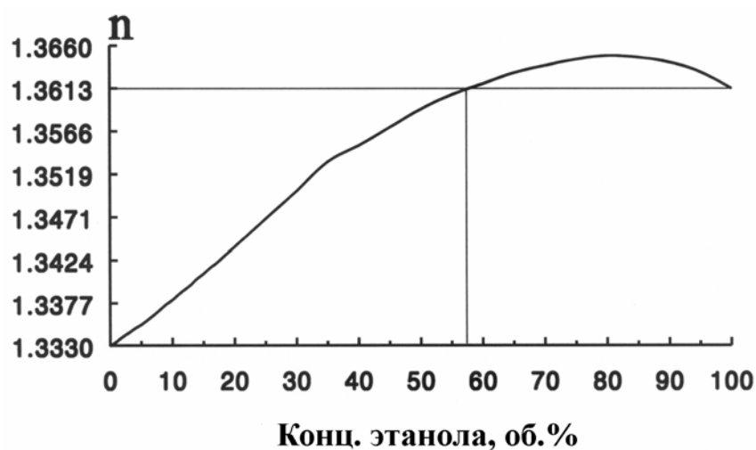
Рис. 1. График зависимости показателя преломления водных растворов этанола от концентрации (об. %).
