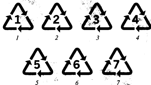
Рис 5-5. Варианты обозначения знаков вторичной переработки изделий из полимеров. 1 — ПЭТФ (Полиэтилентерфталат); 2 — HDPE (Полиэтилен высокой плотности); 3 — PVC (ПВХ, Поливинилхлорид); 4 — LDPE (Полиэтилен низкой плотности); 5 — PP (Полипропилен); 6 — PS (Полистирол); 7 — Другие виды пластика.
