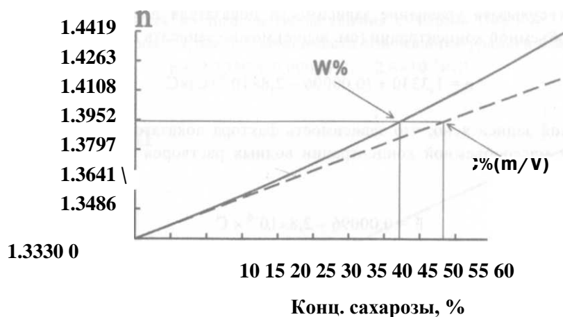
Рис. 5. Графики зависимости показателя преломления водных растворов сахарозы от массообъемной концентрации и от концентрации, выраженной в виде массовой доли.
