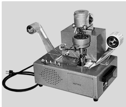
Рис. 42. Общий вид устройства для автоматизированной расфасовки и упаковки лекарственных порошков в полимерную пленку
